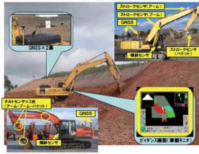
油圧ショベルのマシンガイダンスシステム技術(例)
