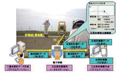
施工管理データを搭載したTSを用いた出来形管理技術(例)
